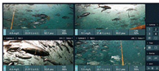
生簀内に海中カメラ設置し養殖魚の状態を遠隔モニタリング
